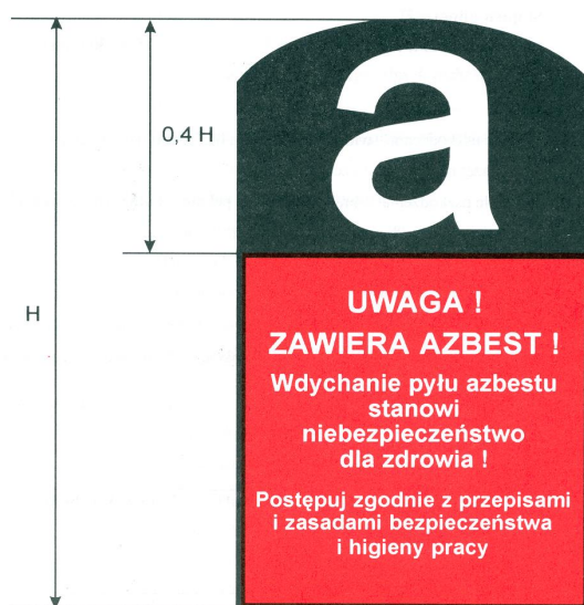
Oznakowanie wyrobów i odpadów zawierających azbest
